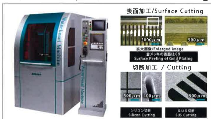
今回紹介する「ウォータービームマシン」は、ウォータージェット技術と最新のレーザー技術が融合した次世代微細加工マシンです。数10  $\mu\text{m}$  径のウォータービームノズルから噴射されたウォータージェット内を、水に吸収されにくいグリーンレーザが全反射を繰り返しながら高速で流れ、ウォータービームが形成されます。このウォータービームがワークに衝突すると、レーザーはそこで初めてワークに吸収され、発熱し、ワークを溶融しつつ、ウォータージェットにより冷却されます。同時に、ウォータージェットで残渣を洗浄除去し、究極のバリレス加工を実現します。熱影響が極めて少ないクリーンな切断、溝切り、表面加工が可能となります。半導体素材、金属、セラミックスなど幅広い材質の加工が出来ます。
