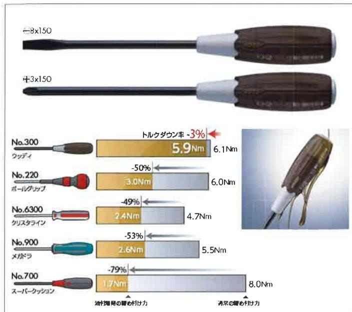
自動車や二輪、産業機械の整備には油がつきものです。油の付着した状況でのドライバー作業は大変ではないでしょうか。この「ウッディドライバー」は締め付け時のトルクに対して、グリップ表面の粗い木材粉が油分の流動を止めます。油付着時の締め付け力が従来製品で50%以下に下がってしまうのに対して、このウッディドライバーは3%しか下がりません。秘密はグリップ部で木材70%とプラスチック30%をの割合で配合した木樹脂を射出成形したものです。木粉を多く入れることで、木柄ドライバーのような天然木材の手になじむ質感や肌触りを感じることができます。お気軽に弊社担当者までお問合せ下さい。
