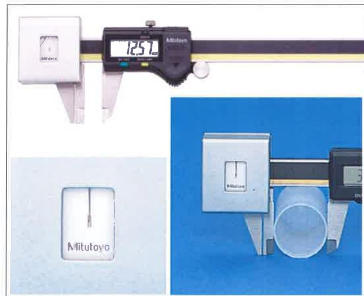
今回紹介する製品は、一定圧力で測定できる株式会社ミツトヨ「デジマチック定圧キャリパ」です。ノギスが測定物を挟みこむ際の圧力を図り、定圧領域時の数値を読み取り、デジタル表示で測定が出来る製品です。形状が変化しやすいプラスチック部品やナイロン製の測定物等、柔らかい素材の測定をされる事が多いお客様にお勧めです。定圧（0.5 N～1.0 N）での測定なので作業者の測定圧の違いによる誤差のバラつきを最小限に抑える事が出来ます。測定範囲は0～180mm、最小表示量は0.01mm、測定精度は誤差±0.05 mmです。測定データの出力端子もあり、パソコンでの測定データの管理も行えます。個人差が出にくく、正確な測定作業の手助けになってくれる製品です。
