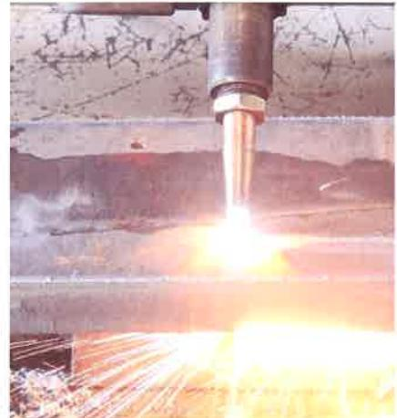
可能です。ハイドロカットに切替えの際は、より安全に使って頂く為に専用の圧力調整器と乾式安全器をお使い下さい。吹管、ゴムホース、水封式安全器はそのまま使用可能です。
