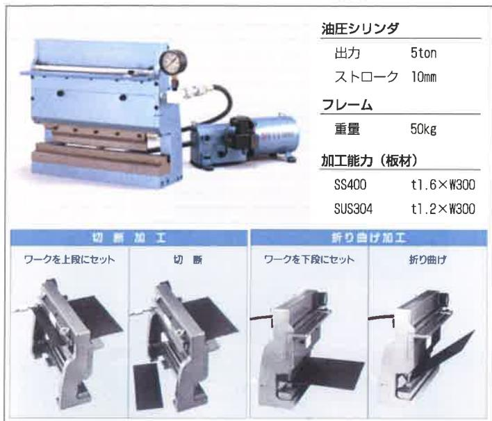
今回ご紹介するのは日東造機株式会社の「薄板金属加工機CB-5（油圧式カット&ベンディングマシン）」です。従来の薄板金属加工は大型の機械でしか加工出来ず、機械を設置する広い場所が必要となり、不便で作業効率も悪いものでしたが、本機は小型の卓上タイプで単相100V電源に対応している為、持ち運びが簡単です。薄板による配電盤や操作盤、治具製作、補修用のアングル等の切断加工や曲げ加工が出来、作業現場での効率が上がります。また、加工時に粉塵や火花などが発生せず加工音も静かです。現場合わせの加工作業が多い御客様にお勧めの製品です。オプションの圧力スイッチを使用すると同じ圧力による繰り返しの加工も可能になります。
